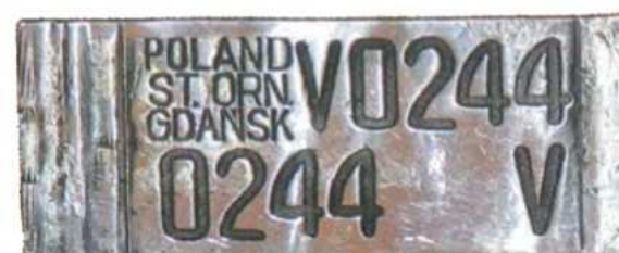
17 | Pierwsze polskie obrączki zdalnie odczytywalne. Niektóre serie miały wytłoczenia oznakowań wypełniane czarną farbą fot. Wojciech Kania
