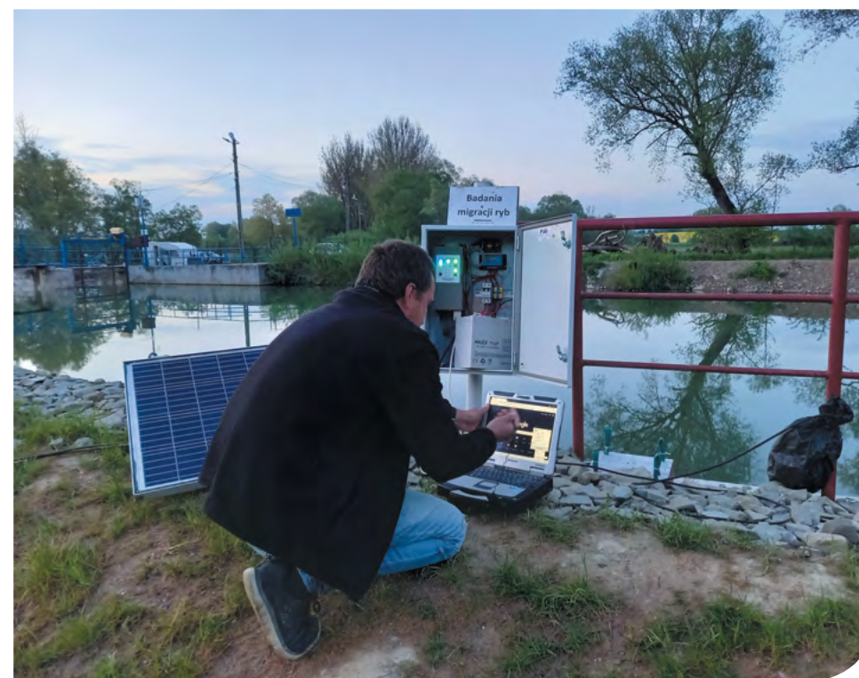
11 | Stacja monitoringowa, czytnik sygnałów LF HDX RFID fot. Archiwum ZBE
