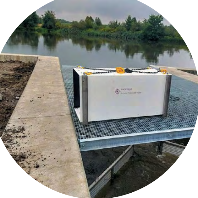
2 | Urządzenie do wizualnej rejestracji migracji ryb firmy Simsonar ( www.simsonar.com )
