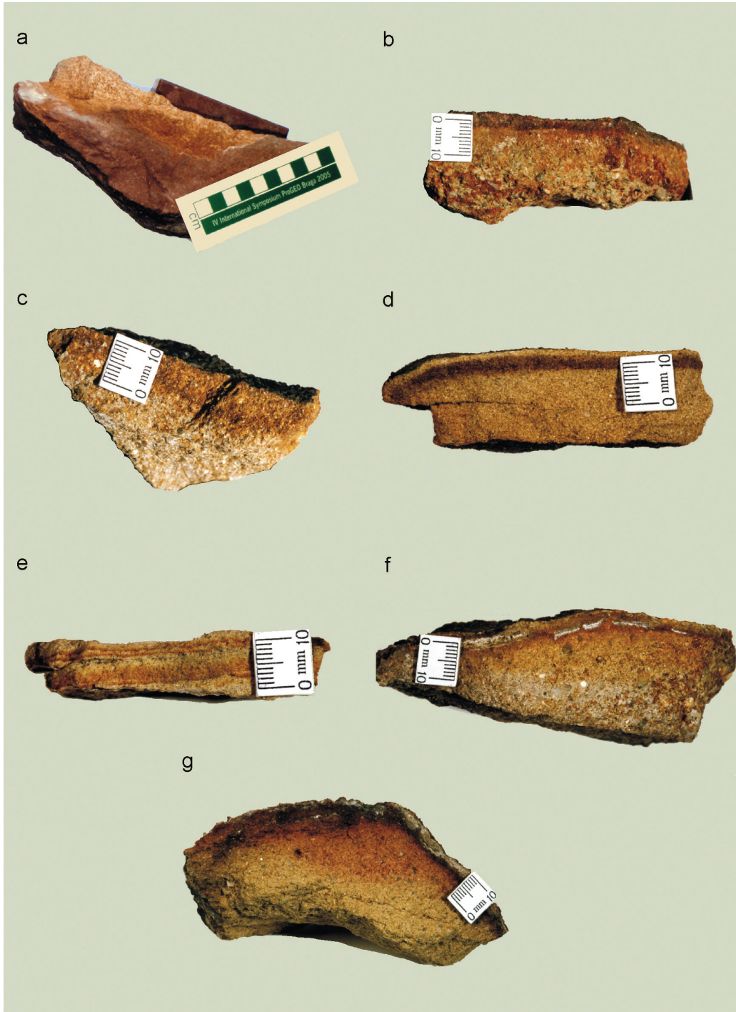
Ryc. 2. Typowe przekroje (a–g) kory wietrzeniowej skałek piaskowcowych Pogórza Karpackiego Fig. 2. Typical cross-sections (a–g) of weathering crusts of sandstone tors in the Carpathian Foothill
