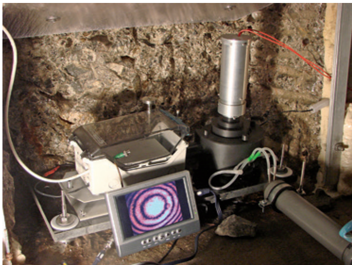
Miernik interferencyjny klinometru na stanowisku pomiarowym
