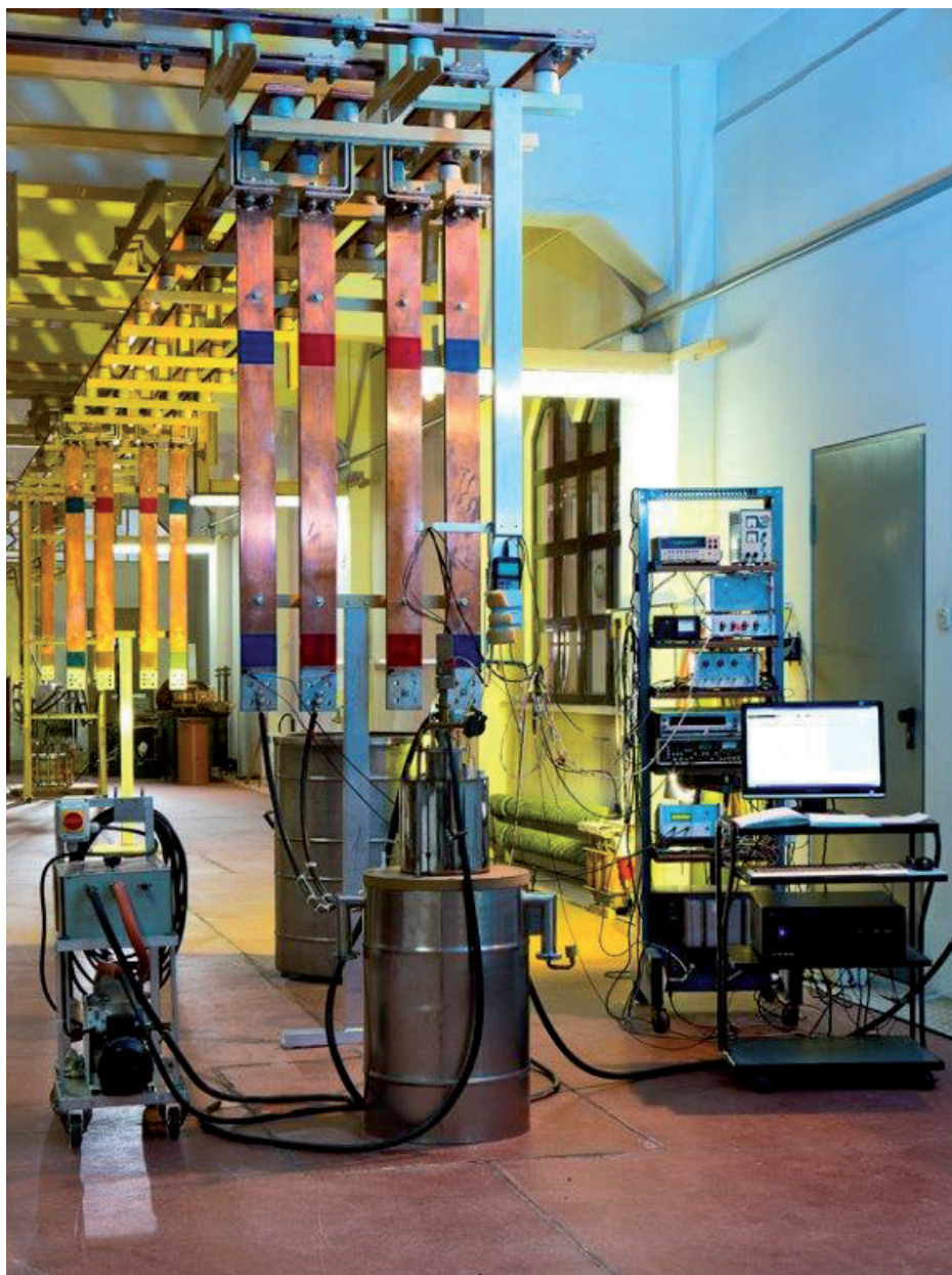
Magnes wytwarzający kwazistacjonarne pole magnetyczne o indukcji do 40 T. Nad magnesem widoczne są miedziane doprowadzenia prądu impulsowego o natężeniu do 50 000 A.
