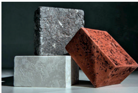
Pianosilikaty – porowate, ogniotrwałe i ekologiczne materiały termoizolacyjne otrzymane w INTiBS PAN
