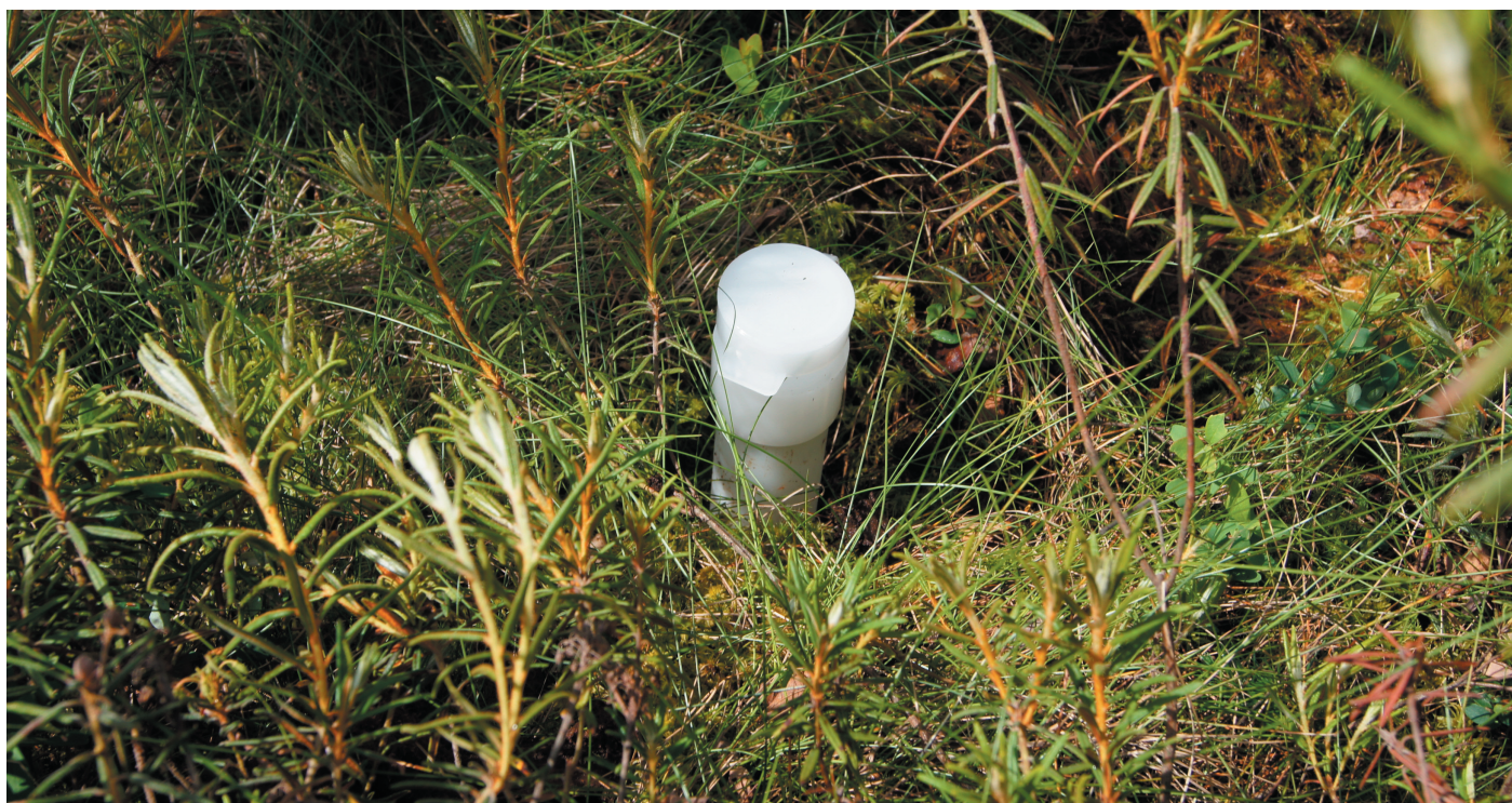
Ryc. 7. Nowocześniejsza wersja piezometru – diver (fot. archiwum PTOP)
